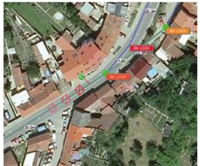
Der Leck-Navigator führt den Anwender per GPS direkt zum Ort der Leckage.
