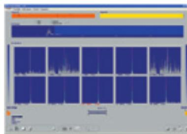
Welche Filter-Einstellungen sind die Besten? Mit der automatischen Filter-Analyse wird diese Frage vom Correlux P-250 selbst beantwortet. Nach der Analyse schlägt das Gerät eine bestimmte Filtereinstellung vor, mit der das
