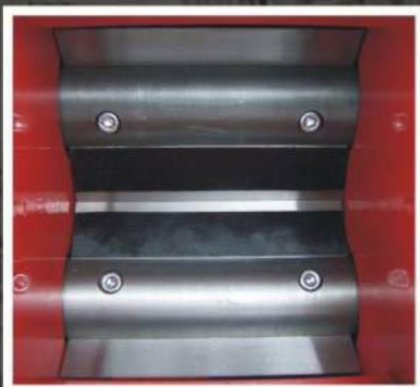
Holzhackermesser – Blick auf den Trichter Der Abstand der Messerklingen beträgt max. 0,2 mm
